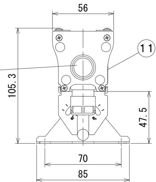
取付穴ピッチは調節可能です。アーム固定ナットをゆるめるとアームを移動できます。ボルト固定専用器具です。M10アンカーボルトで確実に取付けてください。
